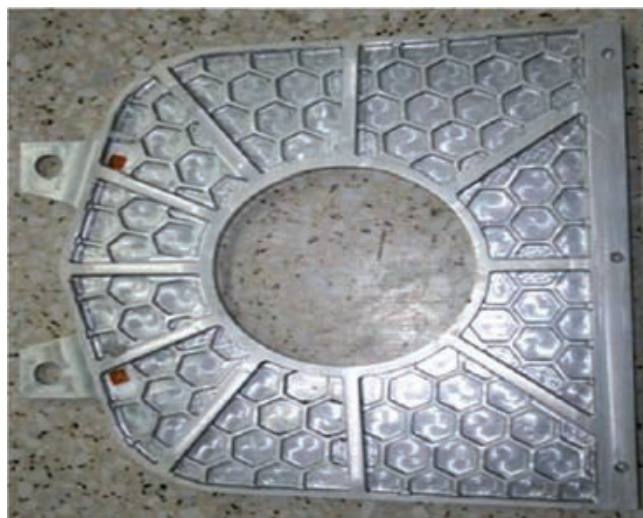
Rys.4 Bioniczny model ramy samolotu; struktura umacniająca została wykonana frezowaniem NC [17].
