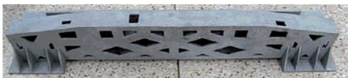
Rys.3. Bioniczny model elementu lotniczego wykonany odlewaniem metodą wytapianego modelu [17].
